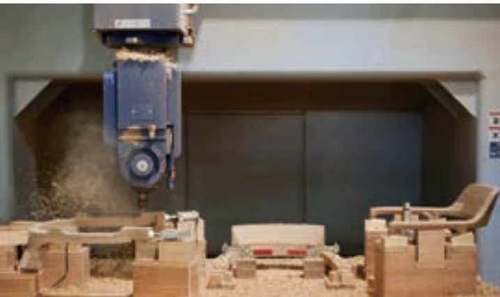
5軸で複雑に動く工作機械。一度に3脚分を加工できる
