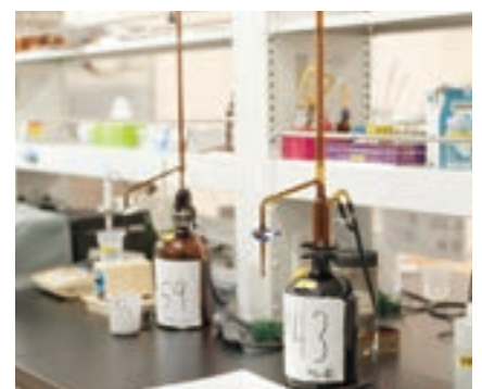
塩分の計測器。製品化には全てを数値化する
