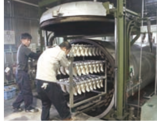
バルカナイズ製法の窯。靴を丸ごと窯に入れる
